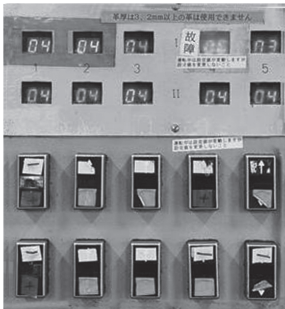
図9 突き棒と上面くぼみの間隔を調節するボタン
