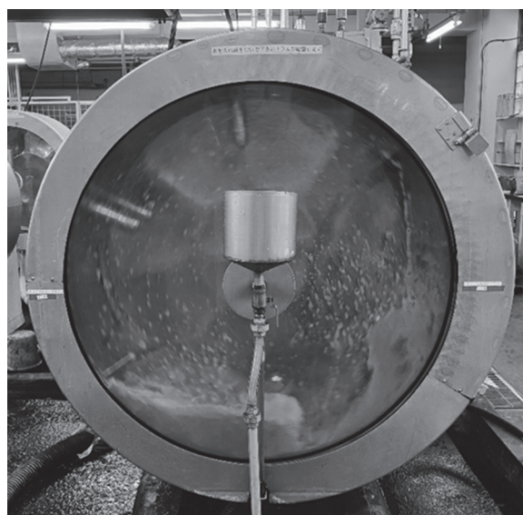
図3. 染色・加脂の試験・開発に用いられているドラム1
