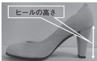
図2 ヒール高さの測定
