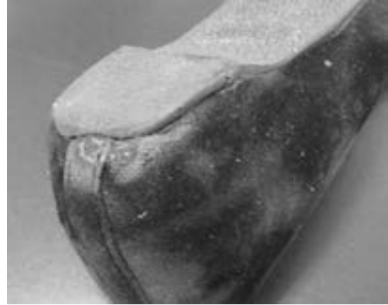
写真7 摩耗が激しいトップピース
