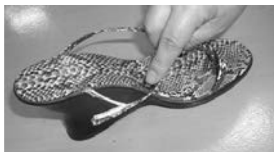
写真8 ストラップの破損
