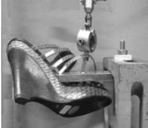
写真10 ストラップの取付強さの測定
