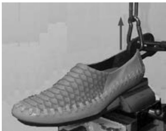
写真3 ウェッジヒールの取付強さ
