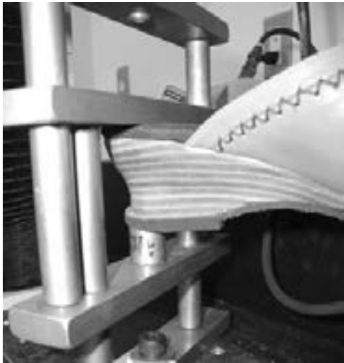
写真6 500Nで押し潰す試験
