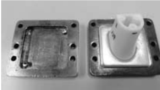
図4 金属製固定皿(左)にヒールを鑄込んだ状態(右)
