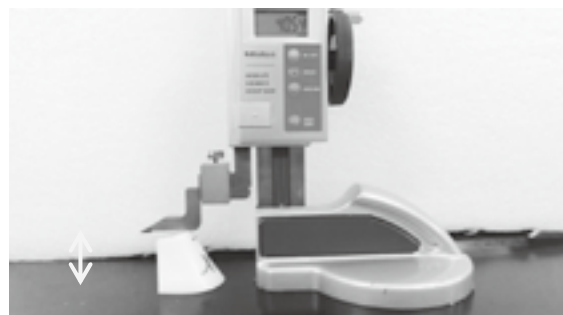
図8 ヒールの高さ測定
