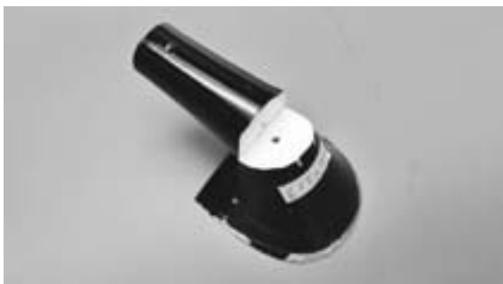
図6 ヒール衝撃試験後のヒール (6.1 J破壊)
